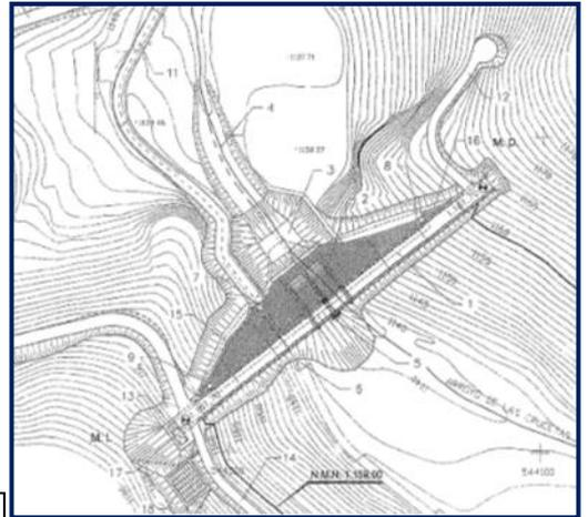
Se trata de una presa de gravedad, de hormigón, de 37 m de altura sobre cimientos y 252 m de coronación. Se apoya en materiales jurásicos formados por niveles carbonatados dolomíticos y niveles arcillosos buzando hacia agua-arriba.
